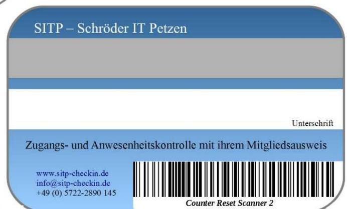
Mit dieser Karte werden die Zähler des Scanner 1 und des Scanner 2 auf den Wert „0“ gesetzt.
